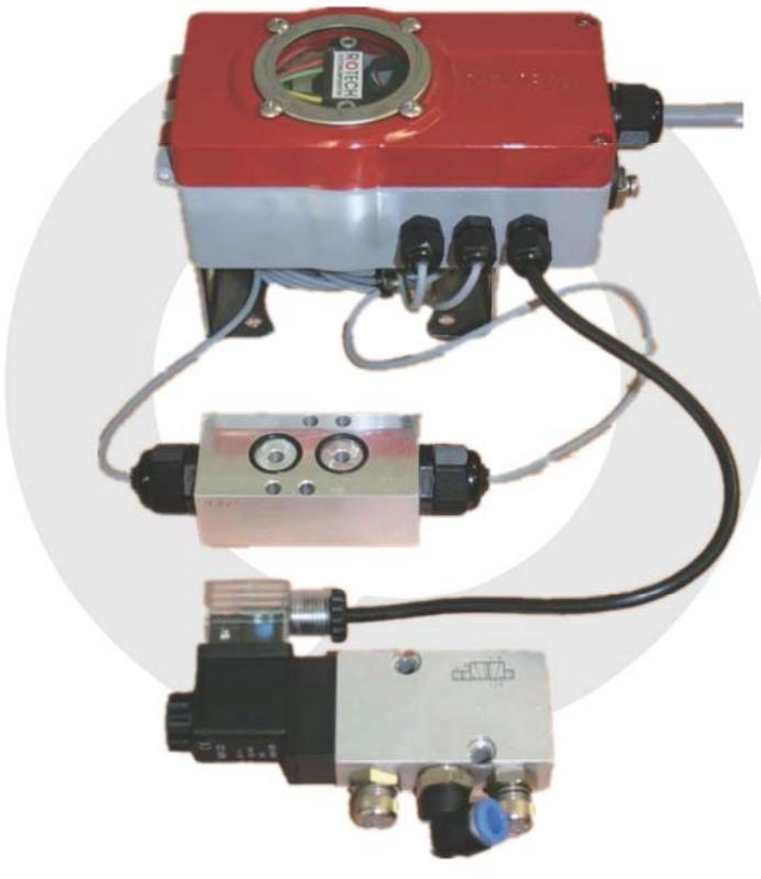
LM型系列用于诊断气动阀门相关关键参数,例如压力,转动角度和扭矩值,并长期记录和存储,作出“阀门+执行机构+控制”的功能安全描述.整个监测记录过程通过辅件和软件以气动或手动操作的方式实现.
